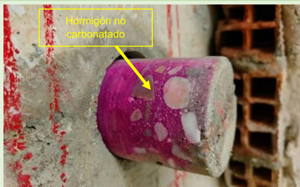
Testigo en pilar 5 de Planta SS
