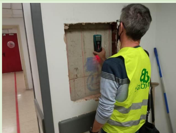
Pilares P. Baja. Localización de armadura mediante pachómetro de sondas magnéticas.
