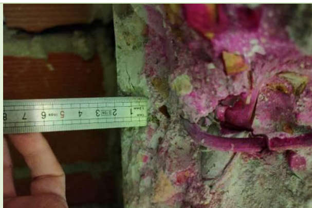
Medición de profundidad de carbonatación en una cata de pilar
