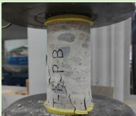
Rotura a compresión en laboratorio.
