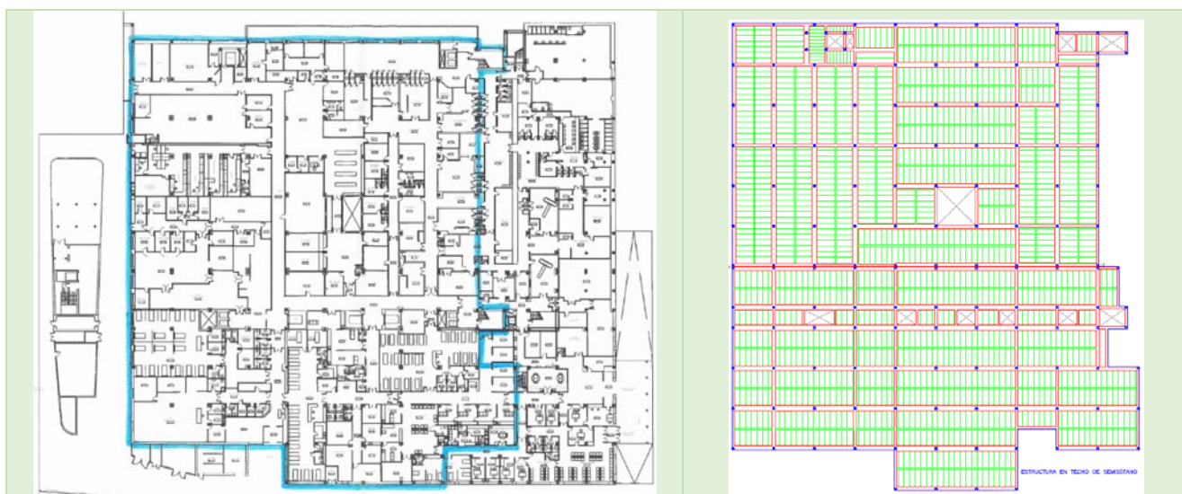
Planta semisótano, distribución actual y esquema estructural del forjado 1º. Techo semisótano.
