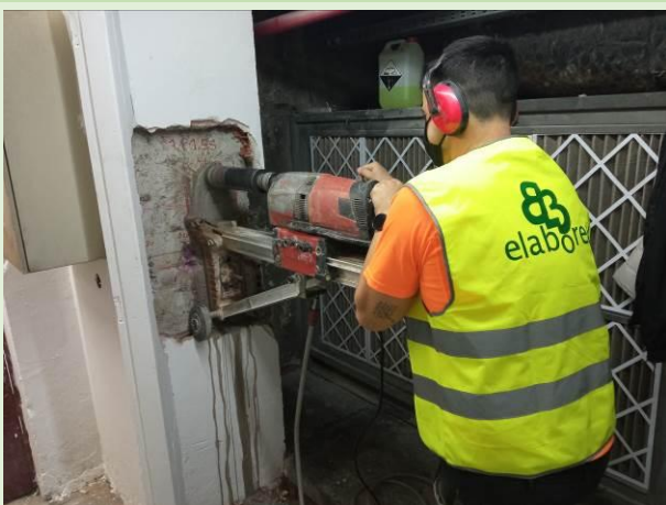
Extracción de probeta testigo en pilar P-1. PSS
