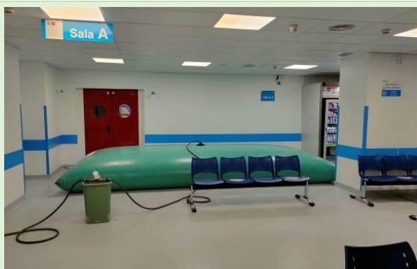
Disposición de carga en prueba nº 1. Sala A
