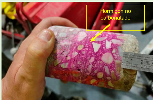
Testigo en pilar 10 de Planta SS
