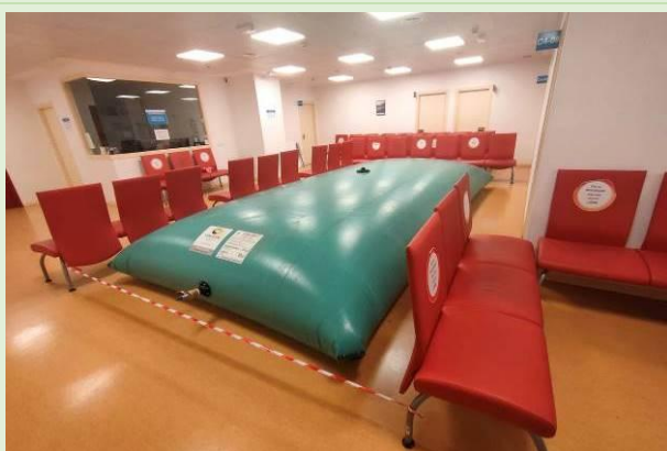
Disposición de carga en prueba nº 2. Sala K.
