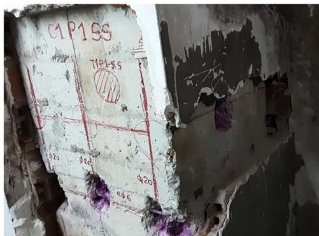
Ensayo de carbonatación en cara X
