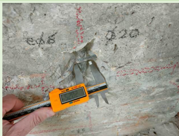
Medición diámetro armadura principal.
