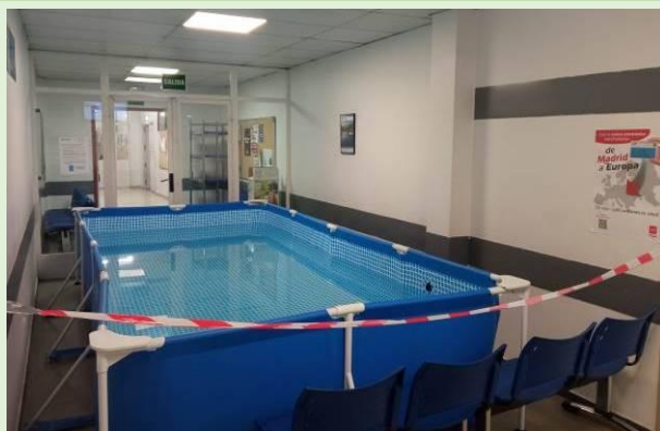
Disposición de carga en prueba nº 2. Sala B.
