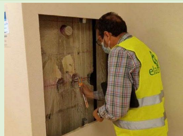
Pilar P. Baja. Toma de datos del armado
