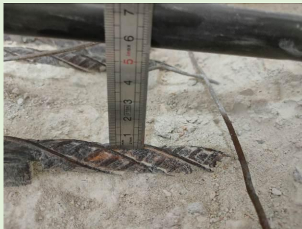
Localización de armadura principal y refuerzos. Medición de diámetros y espesores de recubrimiento.
