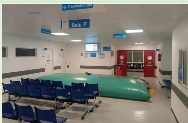
Disposición de carga en prueba nº 4. Sala F
