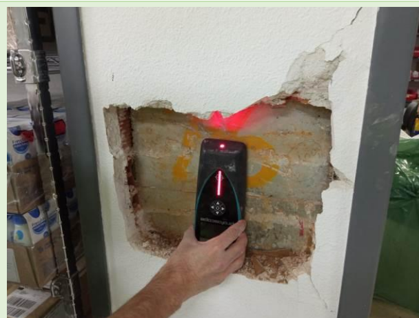
Pilares P. Baja. Localización de armadura mediante pachómetro de sondas magnéticas.
