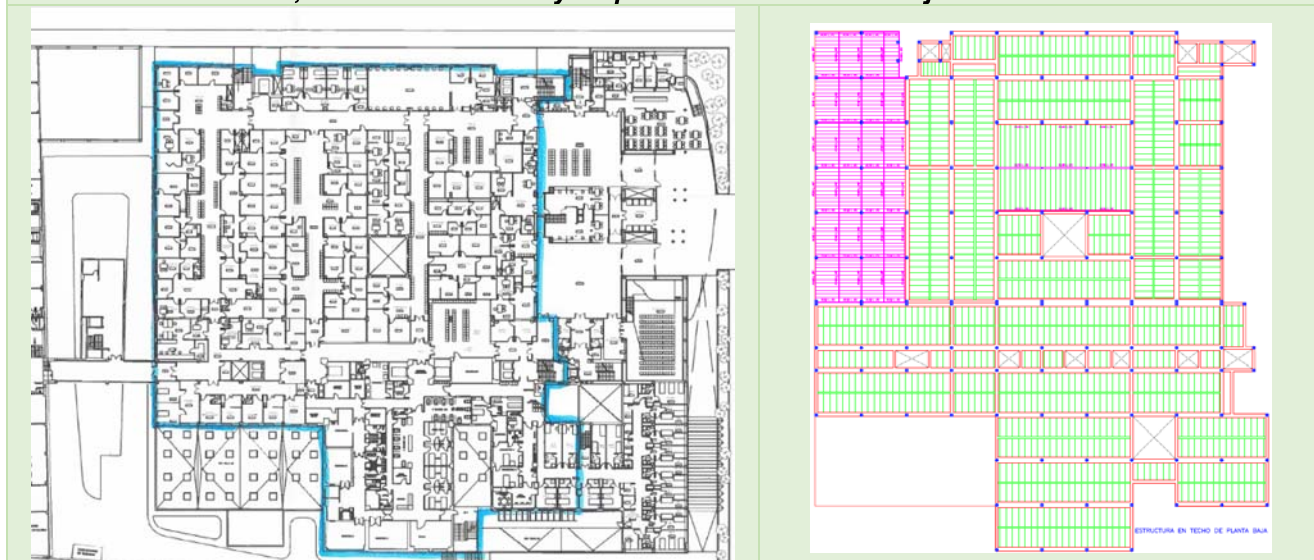
Planta baja, distribución actual y esquema estructural del forjado 2º. Techo de baja.
